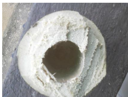
Figure 10: Transverse texture of « bambusa vulgaris »
