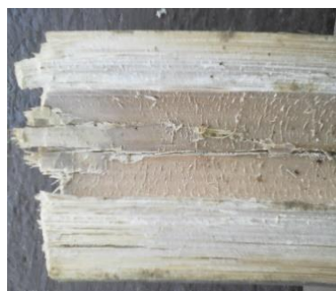
Figure 9: Longitudinal texture of « bambusa vulgaris »
